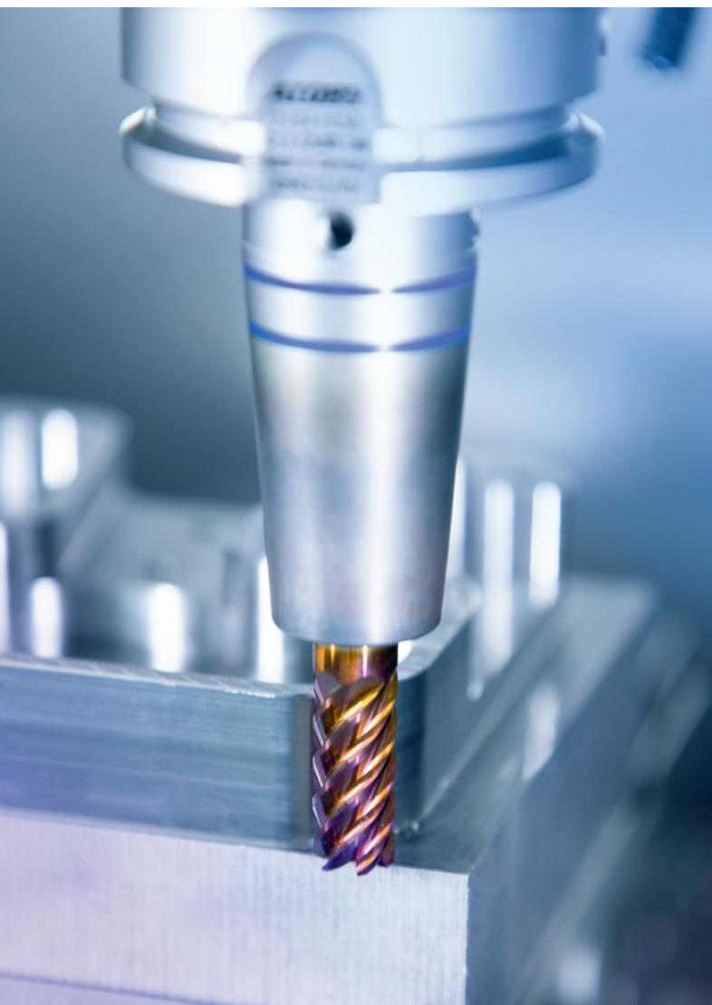
**Stähle mit bis zu 70 HRC in Form bringen:** Das soll laut Hersteller mit Werkzeugen aus dem Atorn VHM-Fräserprogramm schnell und effizient möglich sein.
